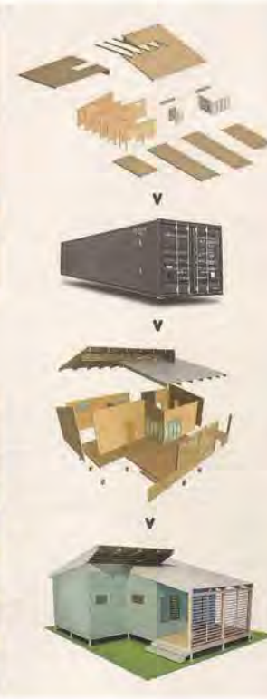
Der japanische Architekt Shigeru Ban entwarf speziell für Nepal eine feuchtigkeitsresistente Architektur aus Papprohren und Holzrahmen, die an Ort und Stelle ausgemauert werden
